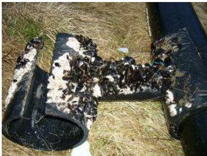
Bilde: Groer på utstyr som må fjernes
